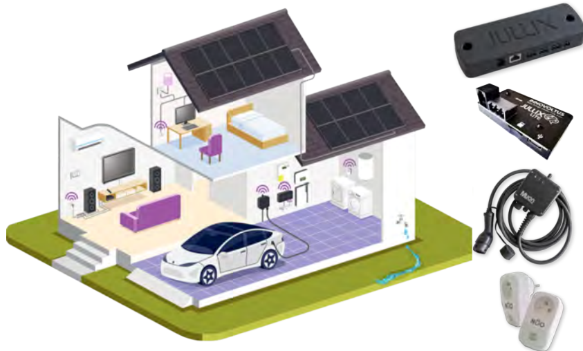
Een gebouw met PV-panelen, batterijopslag, een warmtepomp en een ventilatie-unit kan slim worden geregeld.
